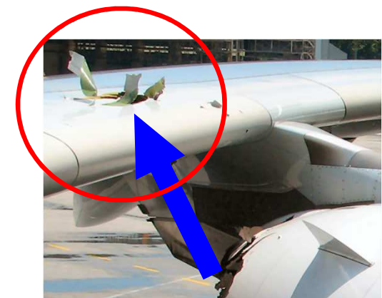
Bsp. Schaden Treibwerk
